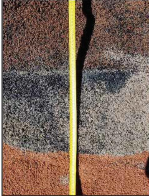
Fotografía 5: Vista superior de los medios granulares secuenciados en la PRB. En este ejemplo, se muestra la zeolita (de color naranja), el carbono granular activado (de color negro) y la zeolita enriquecida con nutrientes (de color blanco). El flujo de agua viaja desde la parte inferior de la fotografía hacia arriba.
